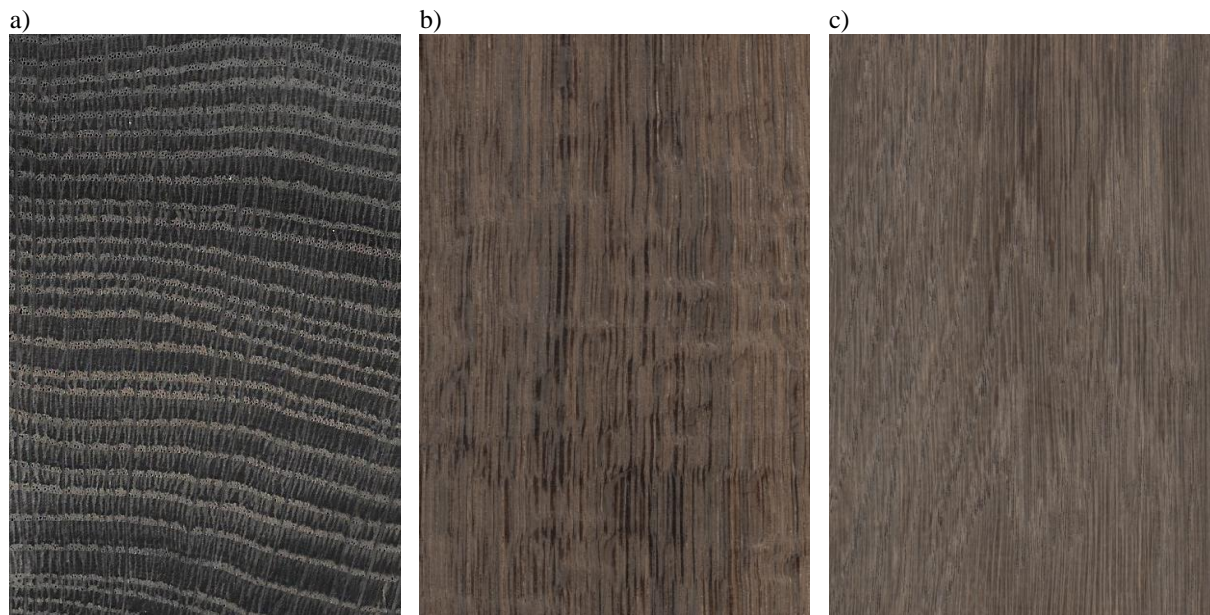
Ryc.5. Obrazy makroskopowe drewna czarnej dębiny: a) przekrój poprzeczny, b) przekrój promieniowy, c) przekrój styczny
