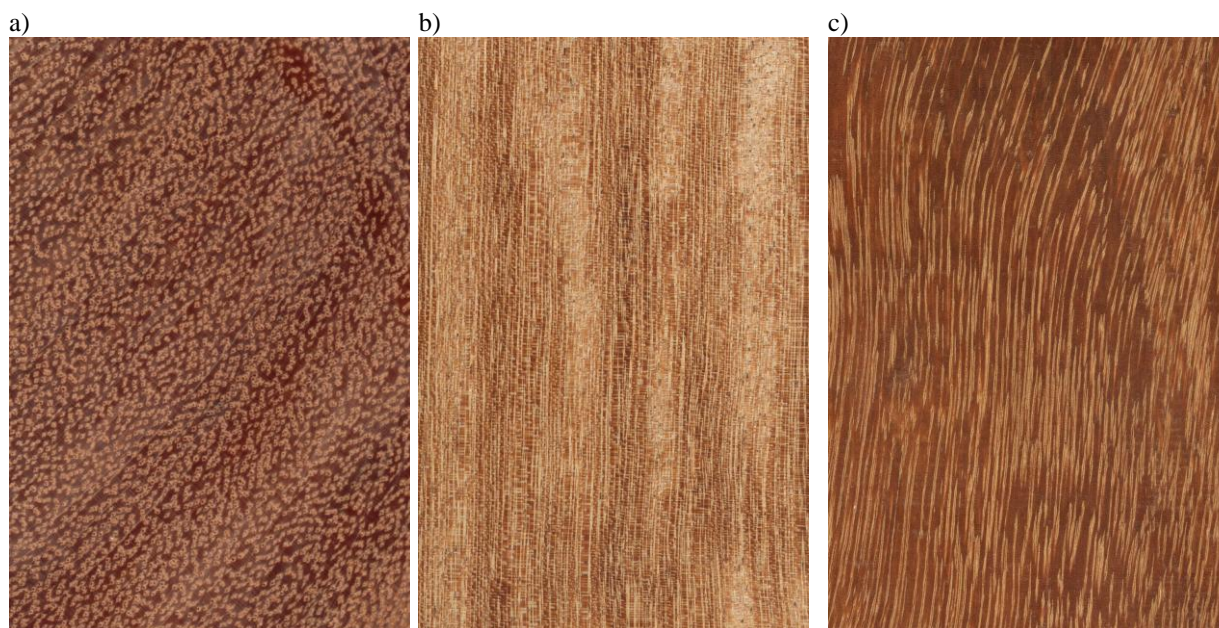
Fot.1. Obrazy makroskopowe drewna kempasu ( Koompassia malaccensis Maing): a) przekrój poprzeczny, b) przekrój promieniowy, c) przekrój styczny
