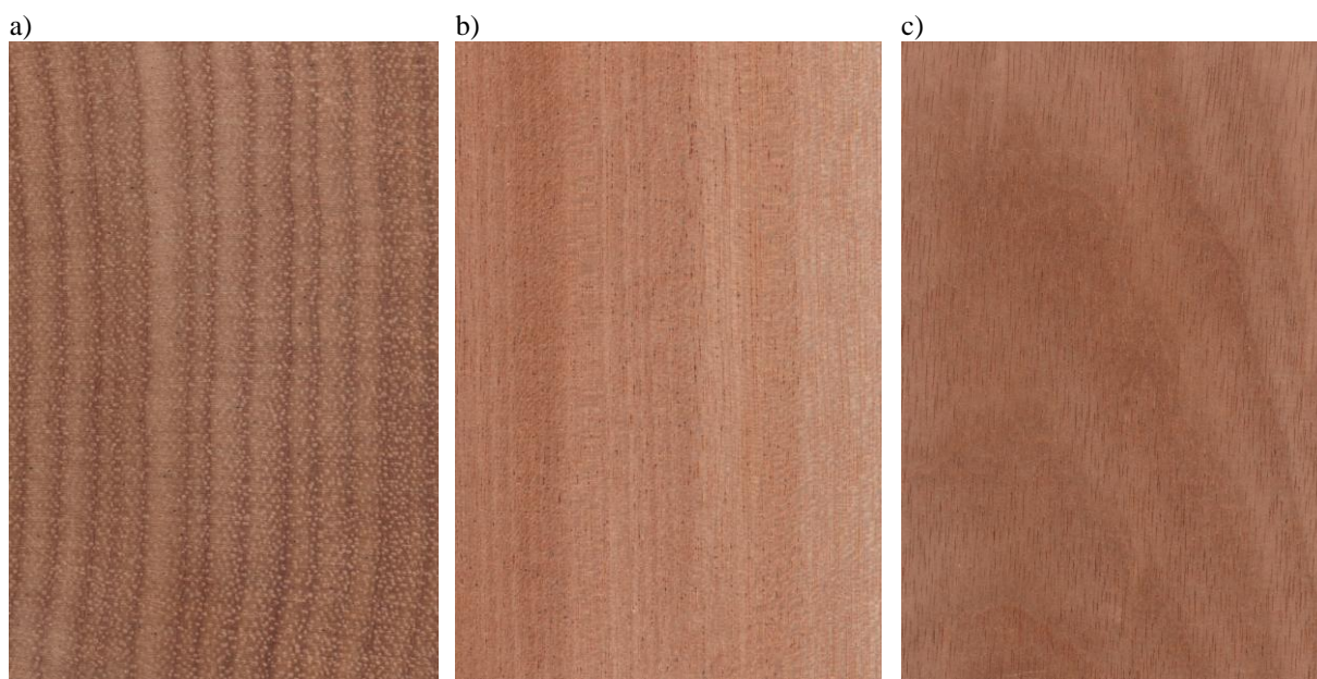
Ryc.1. Obrazy makroskopowe drewna sipo ( Entandrophragma utile Sprague): a) przekrój poprzeczny, b) przekrój promieniowy, c) przekrój styczny
