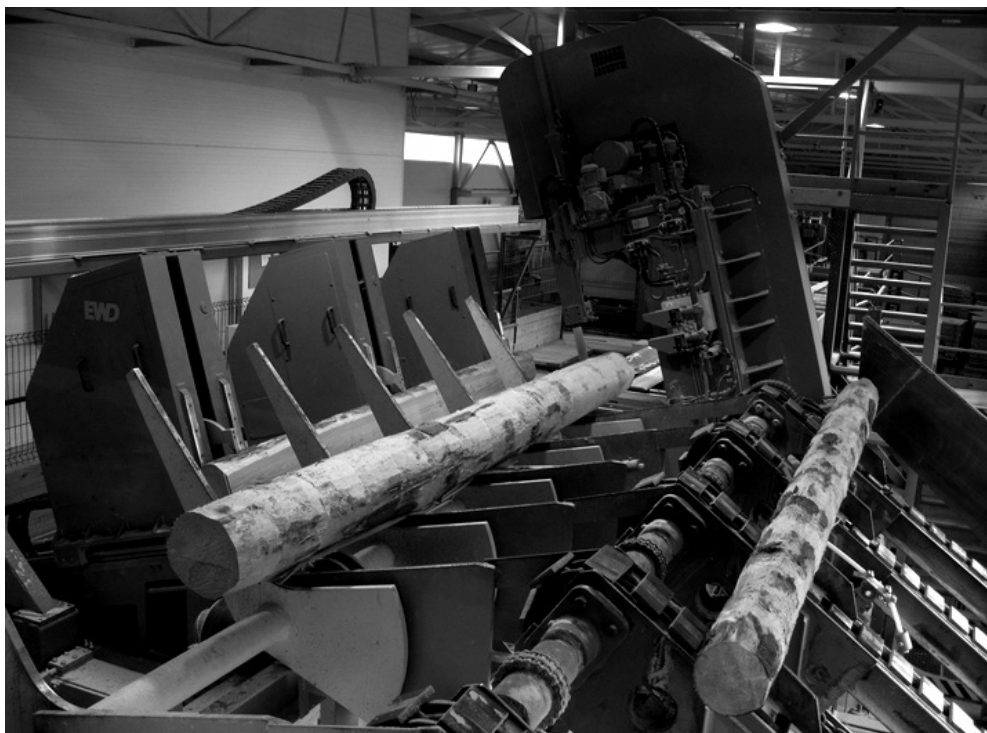
Rysunek 35. Pilarka taśmowa pionowa do kłód przecierająca drewno iglaste
