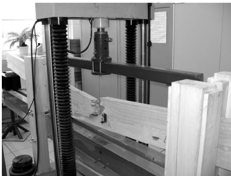
Rysunek 76. Niszczące badanie wytrzymałości tarcicy na zginanie z użyciem maszyny wytrzymałościowej (fot. M. Grześkiewicz)
