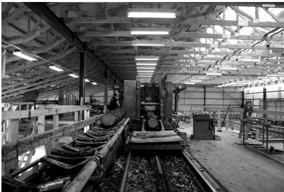
Rysunek 33. Używany trak pionowy ze zdalnie sterowanym wózkiem podawczym w Tartaku Burkietowicz
