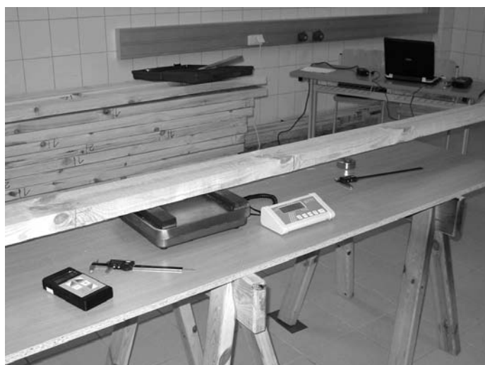
Rysunek 74. Stanowisko do wytrzymałościowego sortowania tarcicy z użyciem urządzenia MTG na WTD SGGW w Warszawie (fot. M. Grześkiewicz)
