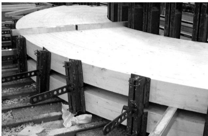
Rysunek 85. Proces klejenia krzywoliniowego dźwigaru o promieniu krzywizny wewnętrznej 3 m (fot. Wiehag)
