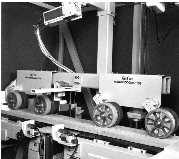
Rysunek 66. EuroGreComat-702: a – zasada działania, b – widok maszyny podczas pracy, widoczne źródło promieniowania (materiały firmy GreCon)
